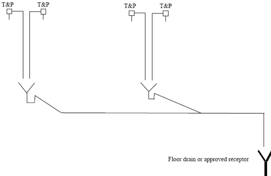
**A-382.33 (8) (d)-2. LOCAL WASTE PIPING SERVING WATER HEATER TEMPERATURE AND PRESSURE RELIEF VALVES**
